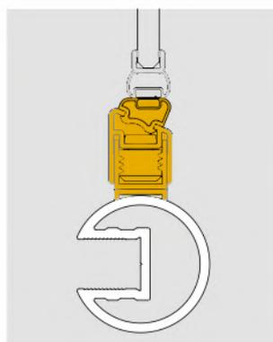
Un profilé spécial de fermeture magnétique permet le raccordement d'une WALK-IN XS Wall avec support de plafond et une porte pivotante intégrale FILIA, p. ex.
