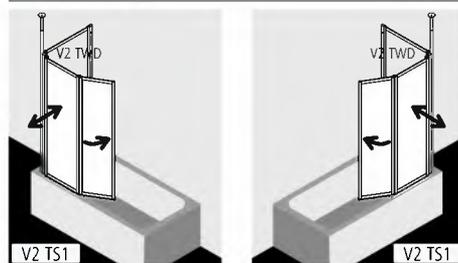
Lors d'une combinaison V2 FW2 et V2 TWD, aucun portillon ne peut être plus large que la paroi fixe. Sinon, la paroi de baignoire ne peut se replier. En combinaison avec V2 TWD en prolongement, le portillon 1 pivote de 90° vers l'intérieur et vers l'extérieur.
