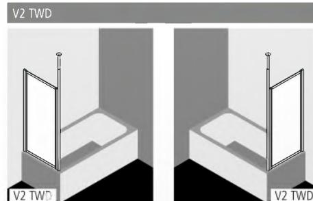
Lors d'une combinaison parois repliables / paroi de baignoire et V2 TWD en angle, aucun portillon ne peut être plus large que la paroi fixe. Sinon, la paroi de baignoire ne peut se replier. En combinaison avec parois repliables / parois de baignoire en prolongement, le portillon 1 pivote de 90° vers l'intérieur et vers l'extérieur.
