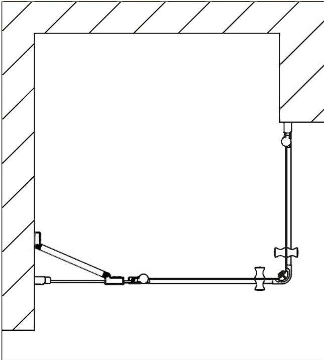
Mur saillant et porte pivotante – la pleine largeur d'accès est conservée.
