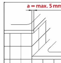
Surépaisseur du rebord de baignoire **a** en cas de raccordement de la baignoire au receveur: **max. 5 mm.**
