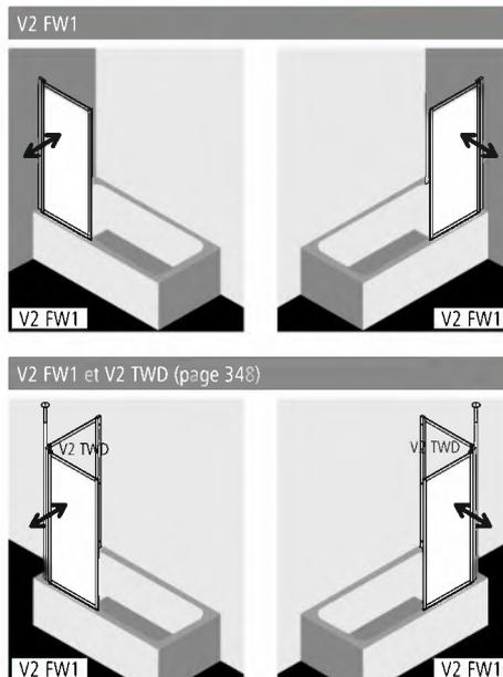
En combinaison avec V2 FW1 et V2 TWD en angle, aucun portillon ne peut être plus large que la paroi fixe.
