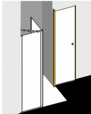
p. ex. paroi arrondie LIGA (portes pivotantes avec éléments fixes) montée avec seulement un élément fixe sur le mur saillant ou accès d'angle IBIZA 2000 2 éléments (portes pivotantes avec éléments fixes) – demi-ensemble monté sans élément fixe sur un mur saillant.
