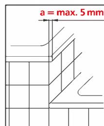
Surépaisseur du rebord de baignoire **a** en cas de raccordement de la baignoire au receveur: **max. 5 mm**.
