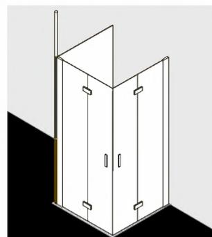
Raccordement d'une porte au tube du support de plafond avec un profilé spécial de raccordement.
