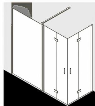
Raccordement d'une porte au profilé carré du support de plafond ou du profilé stabilisateur.
