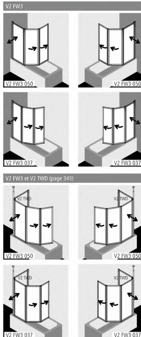
En combinaison avec V2 FW3 et V2 TWD en angle, aucun portillon ne peut être plus large que la paroi fixe. Sinon, la paroi de baignoire ne peut se replier.
