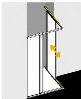
p. ex. d'accès d'angle demi-ensemble IBIZA 2000 sans verre pour l'élément fixe avec rails de guidage supérieur et inférieur continus
