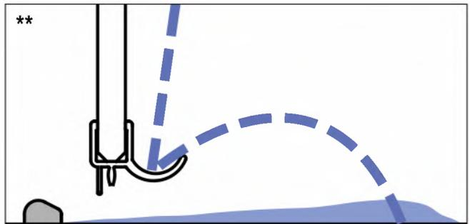
Le joint horizontal spécial en forme de gouttière permet à l'eau de s'écouler tout en restant distancée de la paroi. Ainsi l'eau projetée restera bien mieux dans la douche.
